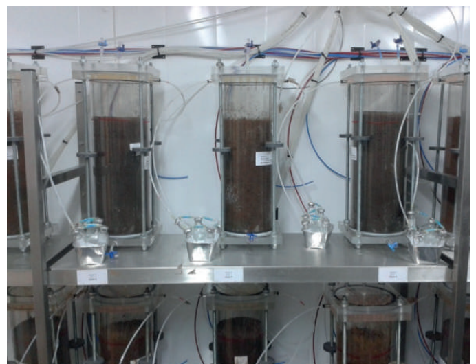
Mikrokosmenanlage mit Bodensäulen.
