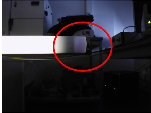
Abb. 4.26.: Das violette Leuchten an der an die Anode der Hochspannung angeschlossenen Wendel (roter Kreis).
