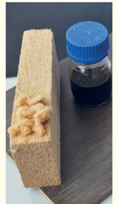
Mit losen Holzfasern und dem Enzym Laccase (rechts) zur gepressten Platte.
