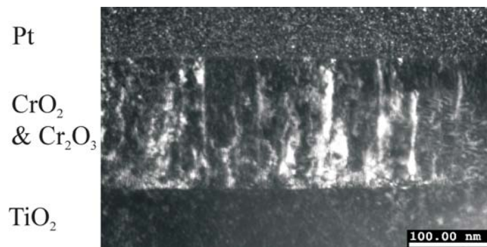
Abbildung 4.25: Dunkelfeldbild des Films parallel zur [001]-Ebene, die Platinschicht resultiert aus der FIB-Präparation.
